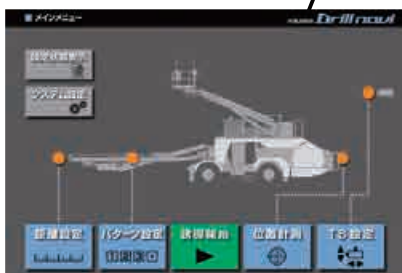
コントロールパネル拡大図 (ナビゲーションシステムのメインメニュー)
